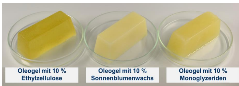
Abbildung 2: Schnittfeste Oleogele auf der Basis von 90 % Rapsöl und 10 % Ethylzellulose (links), 10 % Sonnenblumenwachs (Mitte) sowie 10 % Monoglyzeriden (rechts)
