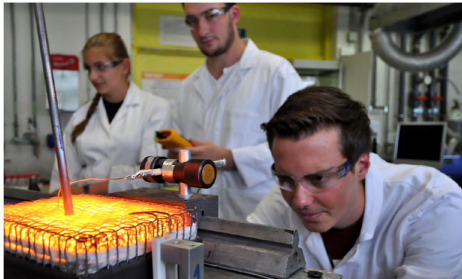
Studenten der Universität Erlangen-Nürnberg messen die Temperaturverteilung und die Emissionswerte an der VKB-Oberfläche.
