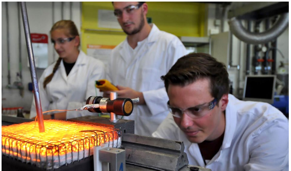
Studenten der Universität Erlangen-Nürnberg messen die Temperaturverteilung und die Emissionswerte an der VKB-Oberfläche.
