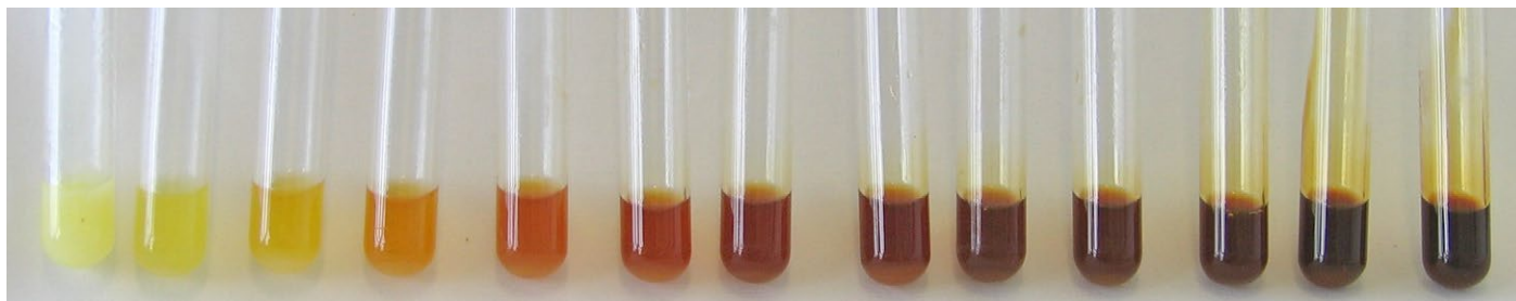
Bräunung eines Molkenpermeates durch Erhitzung bei 120°C in Abhängigkeit von der Zeit: links 0 min, rechts 210 min.
