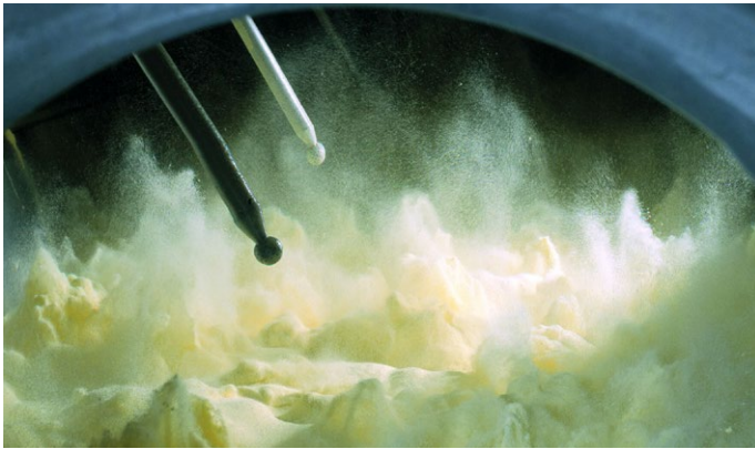
Wirbelbettrocknung eines mit Galactosidase behandelten Molkeproduktes
