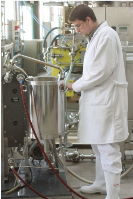
Um bessere Trennergebnisse zu erhalten, bereitet der mit den Forschungsarbeiten beauftragte Doktorand Thomas Strixner die Temperierung des Eigelbs vor der Zentrifugation vor.
