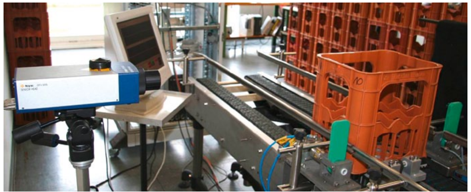
Funktionsmuster zur Schadenerkennung von Getränkegebinden, bestehend aus Kastentransporteur, Schwingerreger, Laservibrometer und PC
