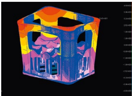
Numerische Simulation der Schwingungen eines Getränkegebindes nach externer Anregung
