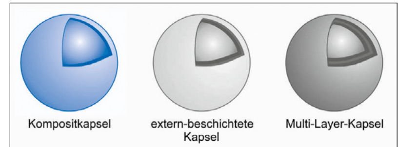
Abb. 4.: Schematische Darstellung der unterschiedlichen Beschichtungsformen.
