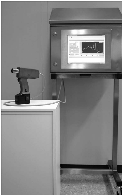
Abb. 5: Funktionsdemonstrator (Zentraleinheit und Messkopf) des Raman-Systems auf einem fahrbaren Untergestell.
